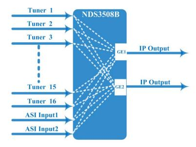
Este sintonizador para gateway IP é um dispositivo de conversão de interface de head-end que suporta saída MPTS e SPTS comutável.
