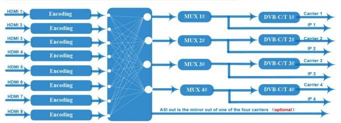
FMUSER FBE208 é um dispositivo profissional de alta integração que inclui codificação, multiplexação e modulação em uma caixa. Ele suporta 8 entradas HDMI e saída DVB-C/T RF com 4 transportes adjacentes e 4 saídas MPTS como espelho dos 4 portadores de modulação via porta DATA (GE). Este dispositivo de função completa o torna ideal para um pequeno sistema de cabeça de CATV e é uma escolha inteligente para sistema de TV de hotel, sistema de entretenimento em bar esportivo, hospital, apartamento...
