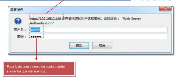
O IP padrão deste dispositivo é 192.168.0.136. Conecte o PI e o dispositivo com um cabo de rede e use o comando ping para confirmar que eles estão no mesmo segmento de rede.
